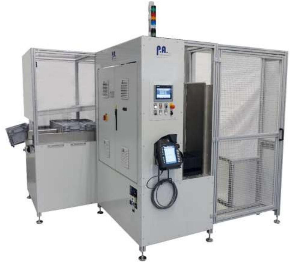
**Bauteilzuführung mit Feeder und Lageerkennung mittels Kamera, Prüfung und Verpackung**
